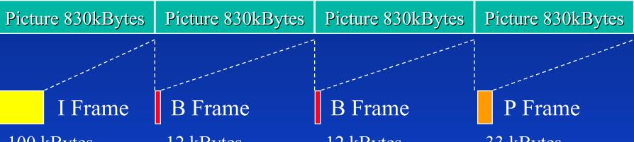
100 kBytes12 kBytes12 kBytes33 kBytesMPEG-2 Compressed SDTV Digital Video Stream - 3.9 Mb/s
